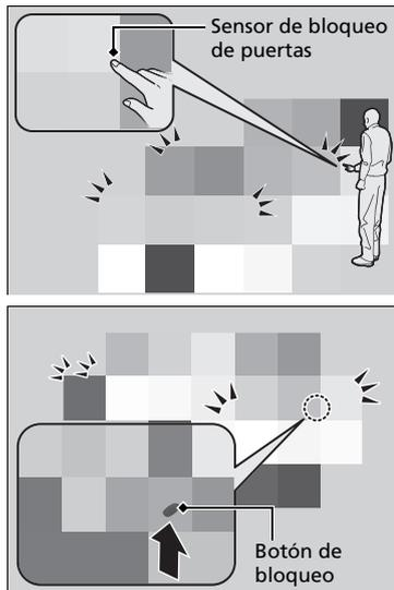
Toque el sensor de la cerradura de la puerta delantera o pulse el botón de bloqueo de la compuerta trasera.
