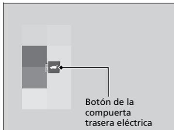
Pulse el botón de la compuerta trasera eléctrica durante más de un segundo para hacerla funcionar cuando el modo de alimentación esté en VEHÍCULO APAGADO.
