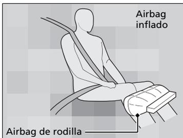
El airbag de rodilla del conductor y el acompañante se despliegan a la vez que los airbags frontales.
