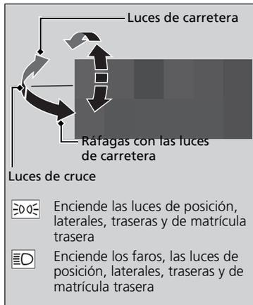
Al girar el interruptor de luces se encienden y apagan las luces, con independencia del ajuste de la modalidad de alimentación.
