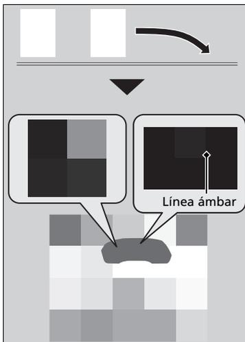
La cámara delantera detrás del espejo retrovisor controla las marcas de carril izquierdo y derecho en blanco o amarillo, y el borde exterior de la carretera (hacia una cuneta de hierba o gravilla) o de vehículos que se aproximan y que se han detectado. Si su vehículo se aproxima a una marca de carril detectada, el borde exterior de la carretera (con una cuneta de hierba o gravilla) o se detectan vehículos que se aproximan sin haberse activado los intermitentes, el sistema se activa.
