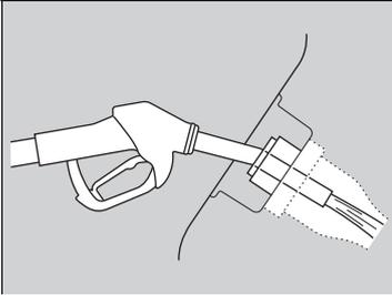
6. Coloque el extremo de la boquilla de llenado en la parte inferior de la abertura de llenado y, a continuación, insértelo lenta y completamente.
