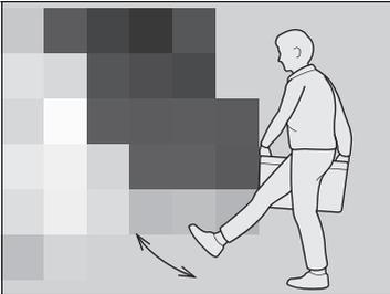
Mueva la pierna hacia delante o hacia atrás durante aproximadamente 1 segundo debajo del parachoques trasero, en la parte central, para abrir o cerrar la compuerta trasera eléctrica mientras lleve el control a distancia de acceso sin llave.
