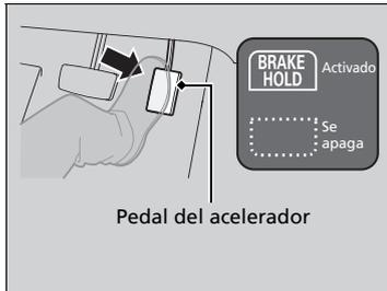
Pise el pedal del acelerador con la transmisión en cualquier posición que no sea **P** o **N**. El sistema se cancela y vehículo comienza a moverse.
