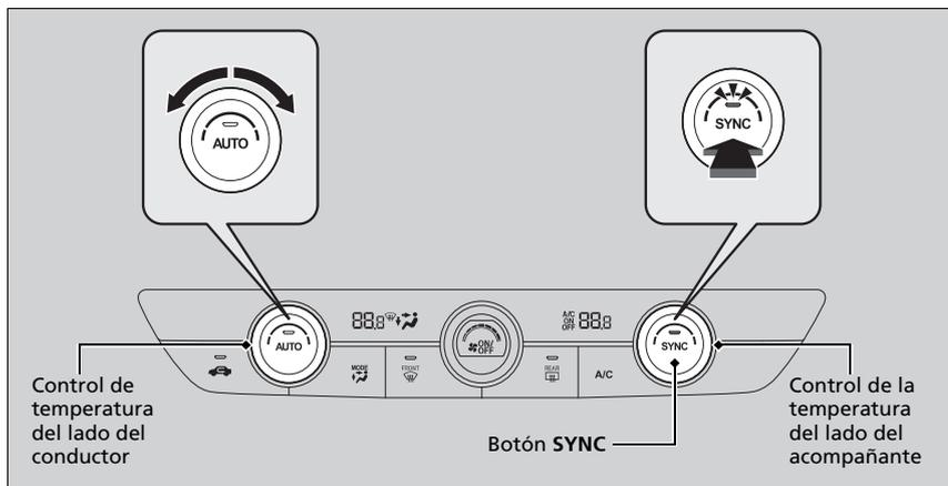
Es posible ajustar la temperatura a la vez para el lado del conductor y del acompañante en modo sincronizado.
