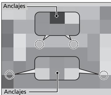
Los anclajes de amarre en el suelo del maletero se pueden utilizar para instalar una red para sujetar objetos.
