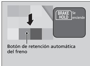
Abróchese el cinturón de seguridad correctamente y, a continuación, arranque el motor. Pulse el botón de retención automática del freno.
