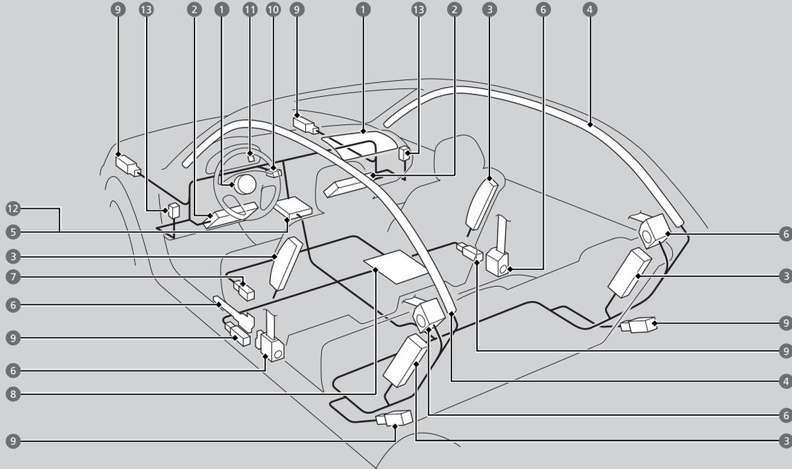
Los airbags frontales, de rodilla del conductor, de rodilla del acompañante, laterales y de cortina se despliegan en función de la dirección y la fuerza del impacto. En caso de vuelco se despliegan ambos airbags de cortina\*. El sistema de airbag consta de:
