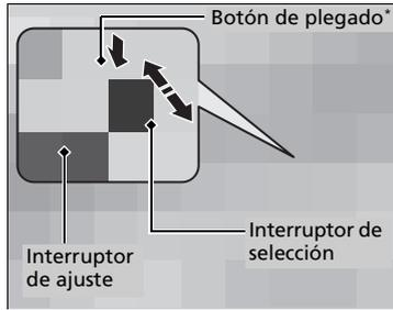
Solamente puede ajustar los retrovisores exteriores cuando el modo de alimentación está en CONTACTO.
