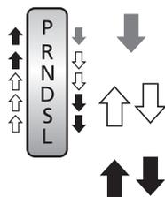
Pise el pedal de freno y pulse el botón de liberación de la palanca de cambios para efectuar el cambio.
