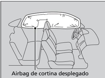
El airbag de cortina está diseñado para desplegarse en un vuelco\* o en un impacto lateral de moderado a fuerte.
