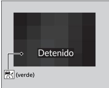
Su vehículo también se detiene automáticamente. El mensaje **Detenido** aparece en el indicador. Cuando el vehículo que le precede se vuelve a arrancar, si pulsa el interruptor **RES/+ / SET/-** hacia arriba o hacia abajo, o pisa pedal del acelerador, el ACC con seguimiento a baja velocidad vuelve a funcionar con la velocidad programada previamente.
