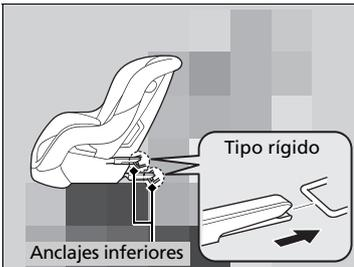
2. Coloque el sistema de sujeción para niños en el asiento del vehículo y, a continuación, fíjelo a los anclajes inferiores según las instrucciones del sistema de sujeción para niños.
