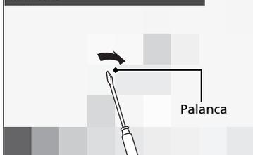
1. Con un desarmador de punta plana retire la tapa de la parte trasera de la compuerta trasera.
