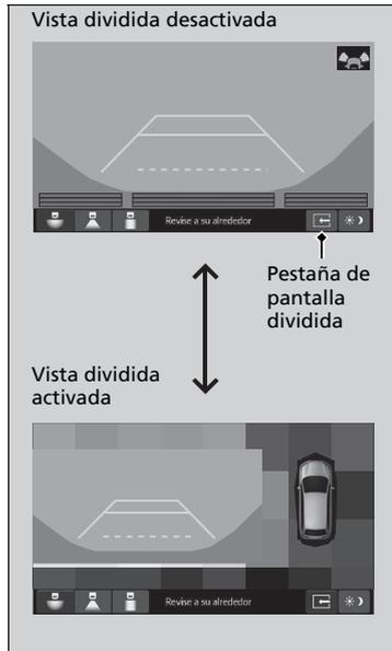
Puede cambiar entre activar y desactivar la vista dividida tocando la pestaña de la pantalla dividida.
