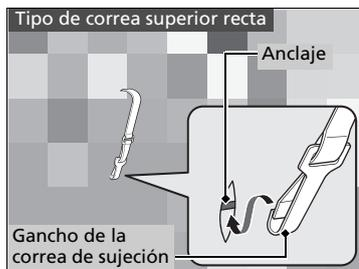
►► Instalación de un sistema de sujeción infantil compatible con anclaje inferior
