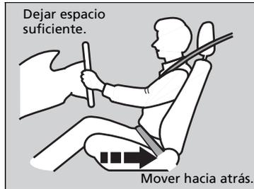
Ajuste el asiento del conductor lo más atrás posible, en una posición que le permita mantener el control total del vehículo. Deberá poder sentarse con la espalda recta bien apoyada en el respaldo y pisar adecuadamente los pedales, sin tener que inclinarse hacia delante, y sujetar el volante con comodidad. El asiento del acompañante deberá ajustarse de forma similar, para que permanezca lo más alejado posible del airbag frontal del salpicadero.
