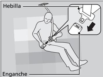
3. Introduzca la hebilla en el enganche. Ajuste adecuadamente el cinturón de seguridad de la misma forma que ajusta el cinturón de seguridad de tres puntos.
