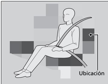
Los airbags laterales se alojan en el borde exterior de los respaldos de los asientos del conductor, del acompañante y los asientos exteriores traseros.
