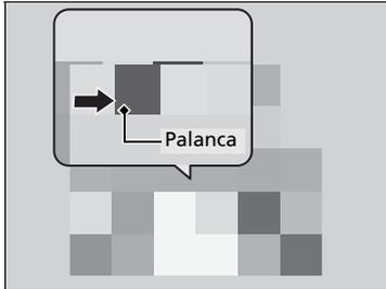
3. Empuje la palanca del cerrojo del cofre (ubicado debajo del borde frontal del cofre hacia el centro) hacia el lado y levante el cofre. Una vez levantado el cofre ligeramente, puede tirar de la palanca.
