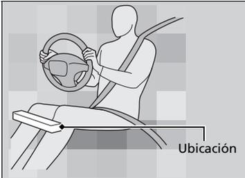
El airbag de rodilla del conductor y el del acompañante están almacenados debajo de la columna de la dirección y de la guantera, respectivamente.
