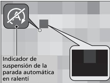
El indicador de suspensión de la parada automática en ralentí se enciende y aparece un mensaje en el indicador cuando el sistema de parada automática en ralentí no se puede activar.
