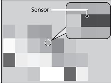
El sistema del aire acondicionado automático está equipado con sensores. No los tape ni vierta líquidos sobre ellos.
