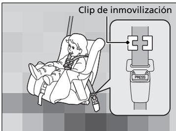
4. Sujete con firmeza el cinturón cerca de la hebilla. Mantenga sujetas las dos partes del cinturón para que no se deslicen por la hebilla. Desabroche el cinturón de seguridad.
