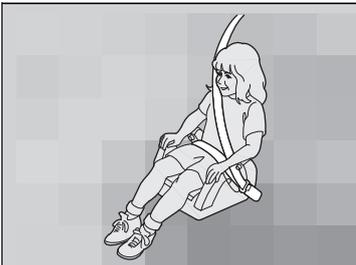
Si no se puede utilizar correctamente un cinturón de seguridad de tres puntos, sienta al niño en un cojín elevador en el asiento trasero. Por la seguridad del niño, compruebe que el niño cumple las recomendaciones del fabricante del cojín de seguridad.
