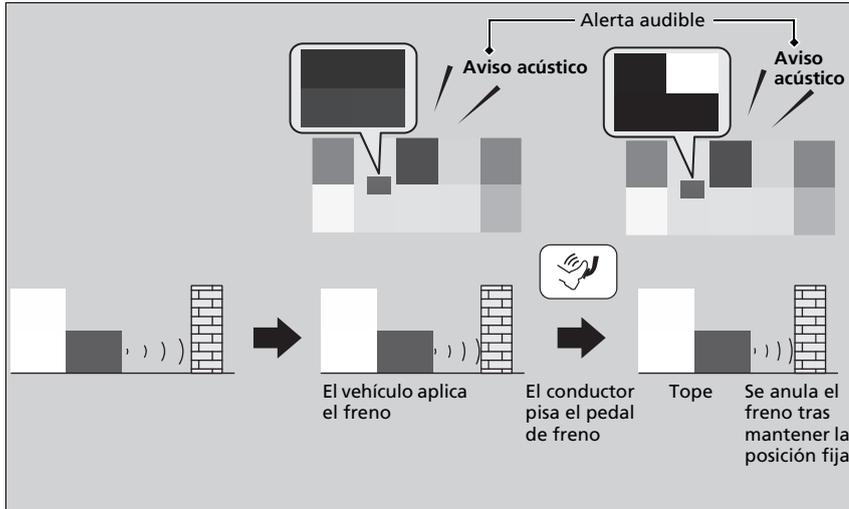
Si solo se apagan los sensores traseros que usa el sistema del sensor de estacionamiento, la función de freno a baja velocidad no funciona con marcha atrás.
