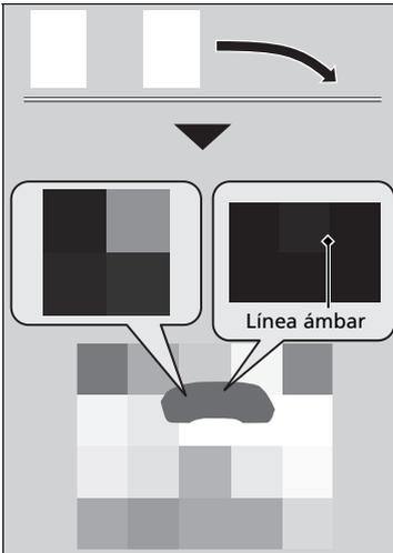
La cámara frontal detrás del espejo retrovisor supervisa las marcas de carril de los lados izquierdo y derecho (blancas o amarillas). Si el vehículo se acerca demasiado a las marcas del carril detectadas sin que se haya activado un intermitente, el sistema, además de emitir una alerta visual, aplica par a la dirección y alerta con vibraciones rápidas del volante, para ayudarle a permanecer dentro del carril detectado.
